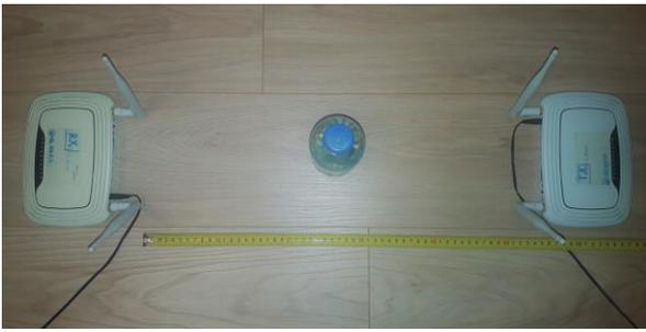
Рис. 1. Внешний вид установки, расстояние между роутерами 50 см
