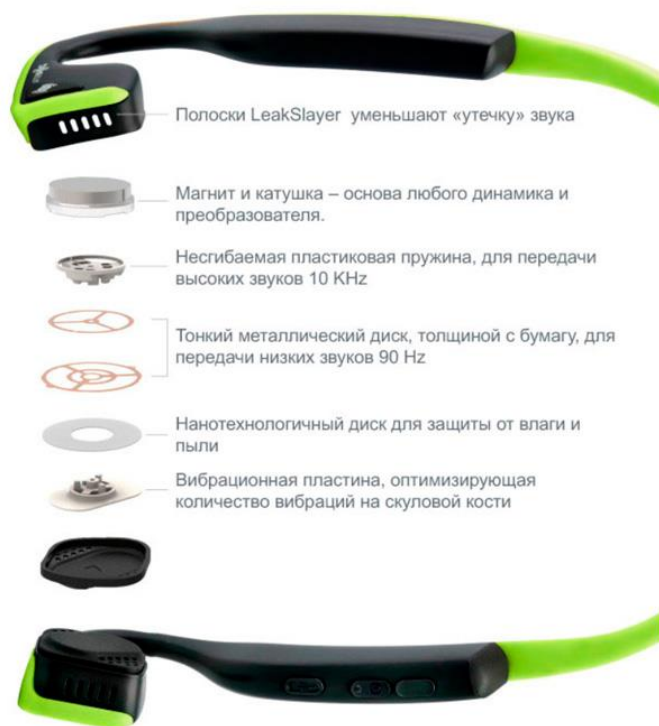
Рис. 3. Внутренне строение наушников костной проводимости
