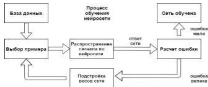
Рис. 5. Процесс обучения нейронной сети. Пример на рисунке обозначает комплексный отсчет
