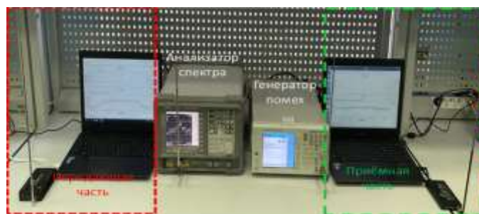
Рис. 1. АПК для исследования влияния непреднамеренных помех на приёмник сигналов с многопозиционной фазовой манипуляцией
