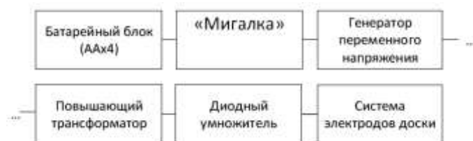
Рис. 3. Структурная схема электропитания ЭДО
