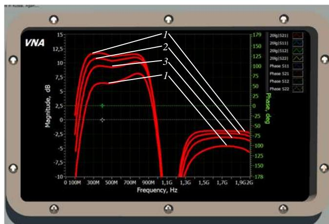
Рис. 3. Зависимости  $S_{21}$  усилителя от токов коллектора
