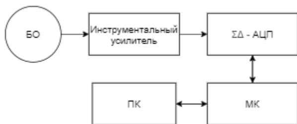
Рис. 3. Структурная схема прибора на основе сигма-дельта АЦП
