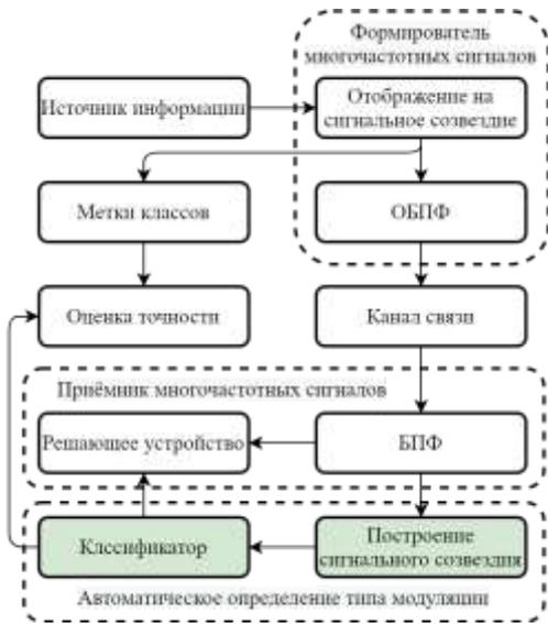
Рис. 1. Блок-схема имитационной модели передатчика и приёмника SEFDM сигналов
