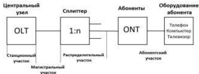
Рис. 1. Структурная схема PON
