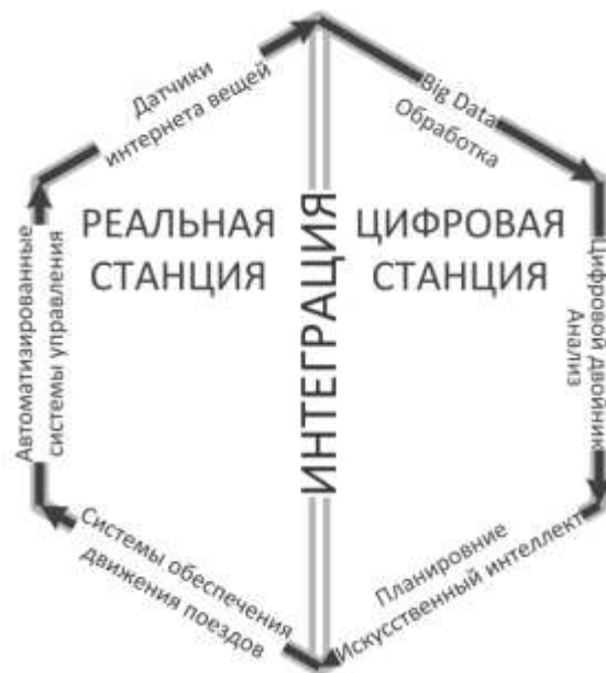
Рис. 1. Схема цифровизации железнодорожной станции
