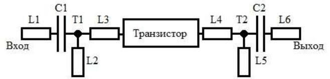
Рис. 2. Упрощённая структура исследуемого усилителя
