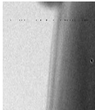
Рис. 1. Рентгеновский снимок, содержащий некорректные пиксели
