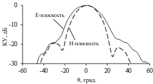
Рис. 8. Экспериментальные нормированные диаграммы направленности в Е- и Н-плоскостях двухполяризованной антенной решётки на основе резонатора Фабри–Перо
