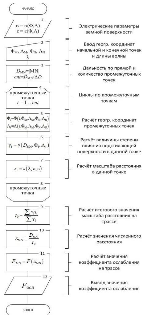
Рис. 3. Алгоритм расчёта коэффициента ослабления электромагнитной волны за счёт поглощения разнородной подстилающей поверхностью
