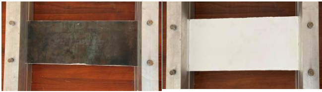
Рис. 5. Исследуемые образцы: слева чистая пластина, справа – со слоем отложений
