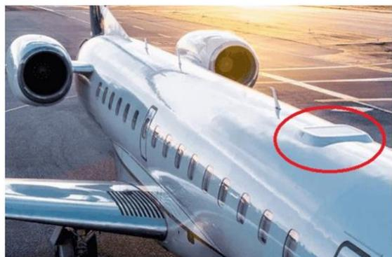
Рис. 3. Внешний вид самолетного АТ ESIM
