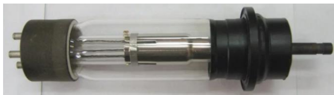
Рис. 1. Рентгеновская трубка БС-1
