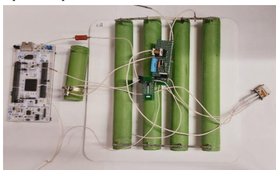
Рис. 5. Собранная моделируемая электрическая схема гибридного реле
