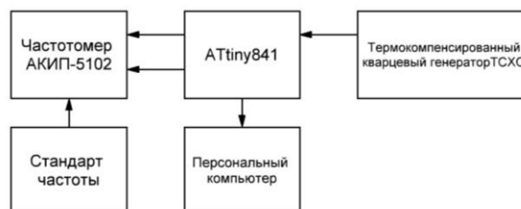
Рис. 2. Структурная схема соединения аппаратуры для исследования точности измерения времени
