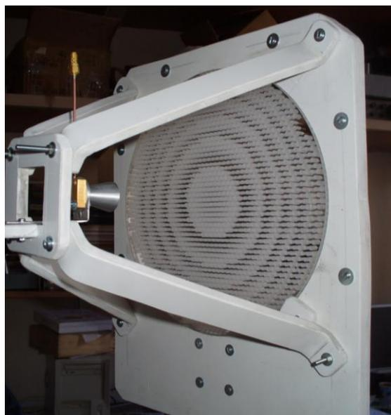
Рис. 3. Перфорированная диэлектрическая линза мм-диапазона
