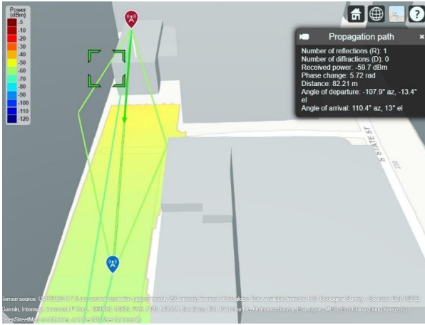
Рис. 5. Модель распространения трех лучей сигнала с 1 отражением
