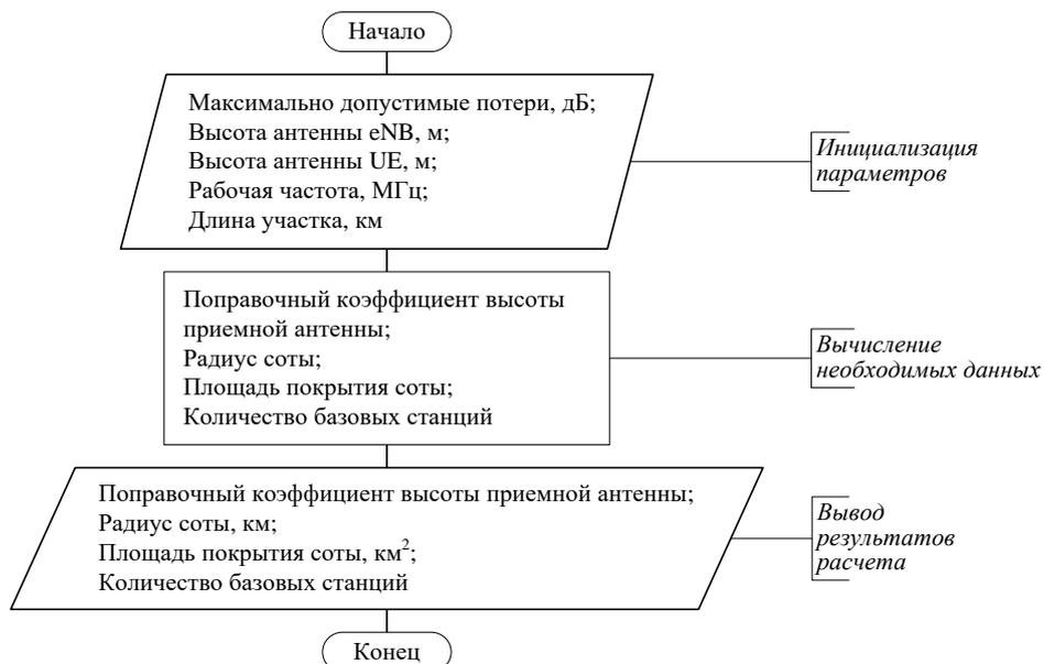
Рис. 3. Последовательность расчета радиуса соты
