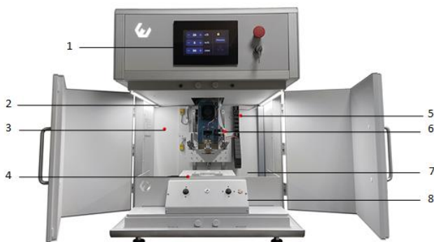
Рис. 3. Внешний вид изделия: 1 – панель управления, 2 – рентгенозащитная камера, 3 – информационная шильда, 4 – система перемещения (СП) стола, 5 – СП источника РИ, 6 – источник РИ, 7 – предметный стол, 8 – панель управления СП и лазерными указателями
