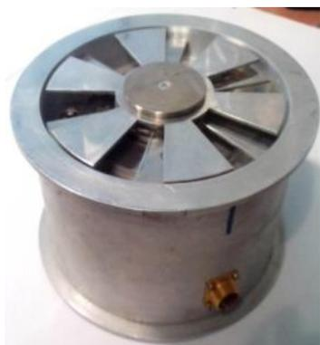
Рис. 2. Электростатический флюксметр
