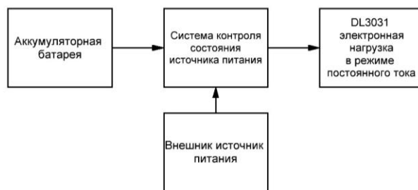
Рис. 3. Структурная схема измерительного стенда для определения емкости аккумуляторной батареи с помощью встроенного в источник питания программного обеспечения
