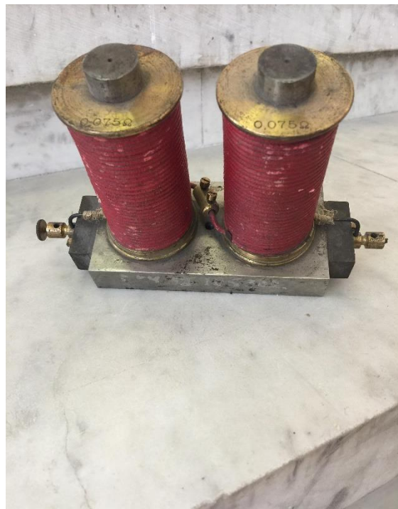
Рис. 1. Детали настольной динамоэлектрической машины для лабораторных опытов по чертежам профессора И. И. Боргмана
