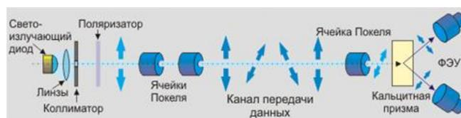
Рис. 1. Канал связи с квантовым шифрованием
