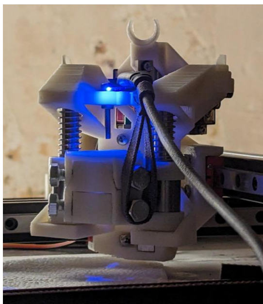
Рис. 3. Процесс замера собственной частоты колебаний робота
