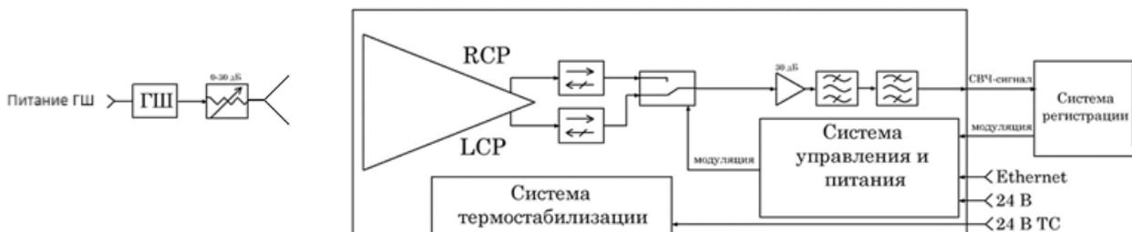
Рис. 3. Функциональная схема приемно-регистрающей системы
