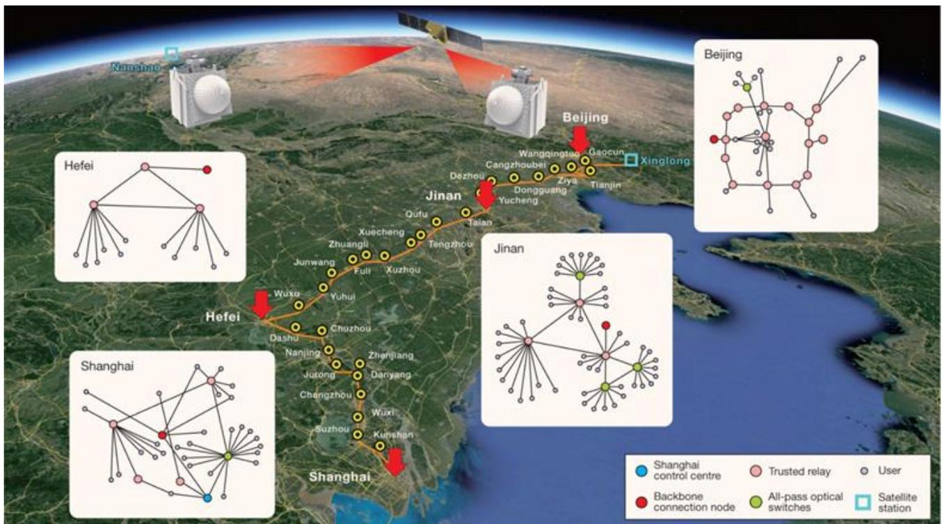
Рис. 1. Интегрированная квантовая коммуникационная сеть «космос-земля», объединяющая крупномасштабную волоконно-оптическую сеть из более чем 700 волоконно-оптических линий связи и две высокоскоростные линии связи «спутник-земля» в свободном космосе
