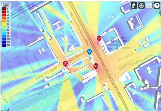
Рис. 2. Карта покрытия с использованием штыревой антенны
