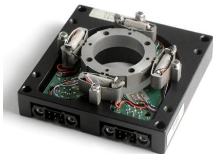
Рис. 4. Типовая реализация сборки пьезоактуаторов для смещения сенсора [4]
