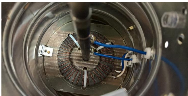
Рис. 7. Размещение трансформаторов тока в корпусе измерителя
