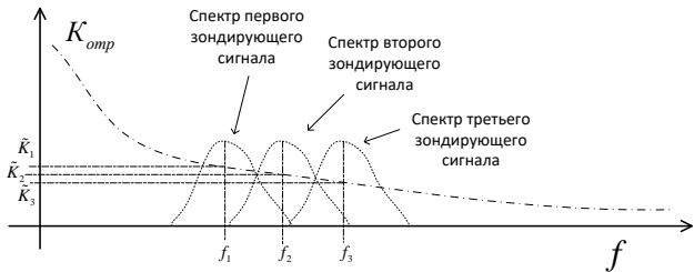
Рис. 2. Спектральная диаграмма оценок коэффициентов отражения
