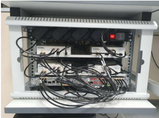
Рис. 2. Основные элементы макета: платы, сервер точного времени и транслятор
