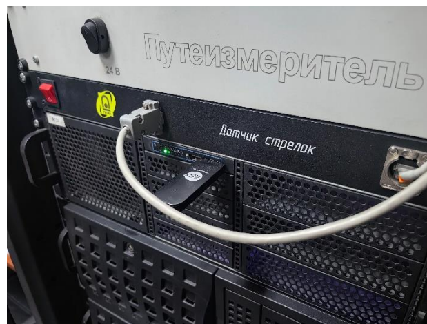
Рис. 3. Подключение 4G модема мобильного оператора связи для обеспечения интернетом МДК на всем пути следования
