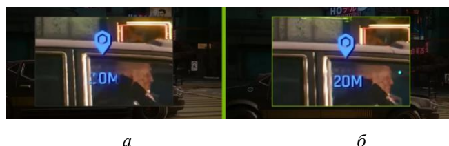
Рис. 2. Пример искажений мелких деталей на видеоряде при использовании нейросетевого метода Nvidia DLSS (Deep Learning Super Sampling) (a) и исходные данные (б) [2]
