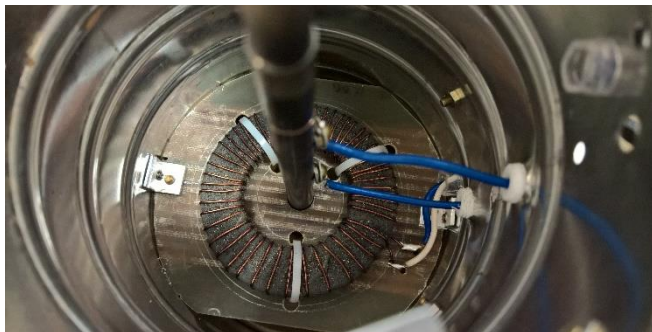
Рис. 7. Размещение трансформаторов тока в корпусе измерителя
