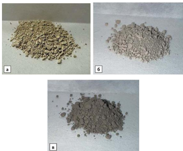
Рис. 1. Образцы модифицированных порошков ZnO: а – Ag (0,2 масс.%), б – Ag (0,5 масс.%), в – Ag (2 масс.%)
