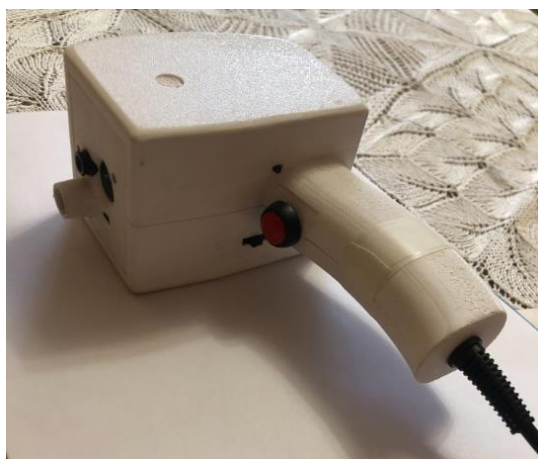
Рис. 3. Опытный макет тепловизора
