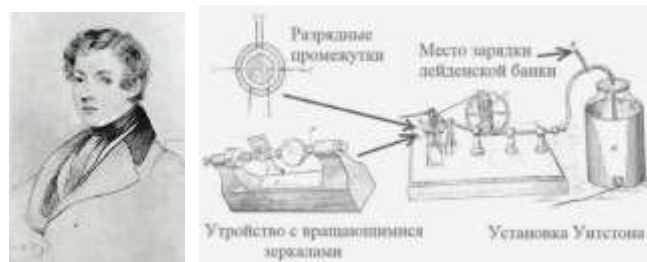
Рис. 3. Английский физик сэр Ч. Уитстон (1837) и его установка для изучения искрового разряда
