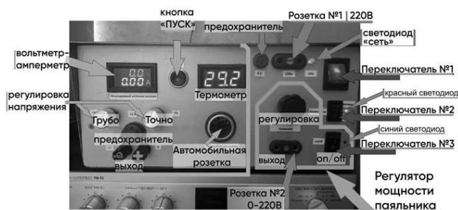
Рис.4. Лицевая панель многофункционального лабораторного БП
