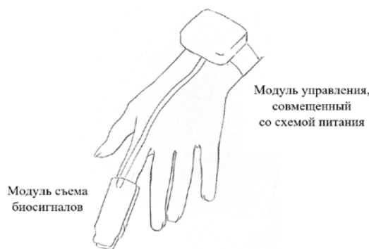
Рис. 1. Архитектура разрабатываемого устройства
