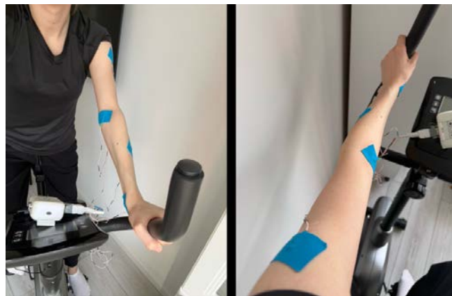
Рис. 1. Фиксация температурных датчиков на теле испытуемого
