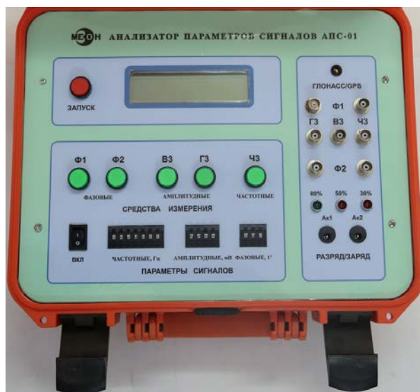
Рис. 3. Опытный образец комбинированного анализатора параметров радиосигналов
