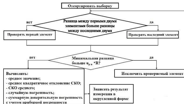
Рис. 2. Алгоритм вычисления погрешностей прямых измерений
