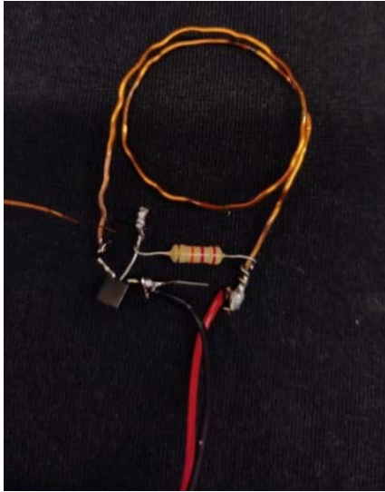
Рис. 3. Соединения с первичной обмоткой
