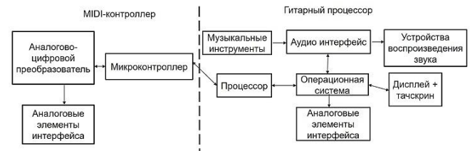
Рис. 3. Архитектура разработанного гитарного процессора вместе с MIDI-контроллером
