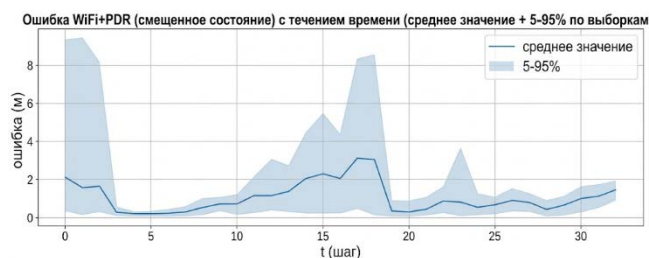
Рис. 3. Изменение ошибки позиционирования при совместной обработке Wi-Fi и PDR при смещённом начальном состоянии: среднее значение и интервал 5–95 % по сериям моделирования
