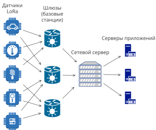
Рис. 4. Описываемый в статье пример применения технологии LoRaWAN для мониторинга поездов
